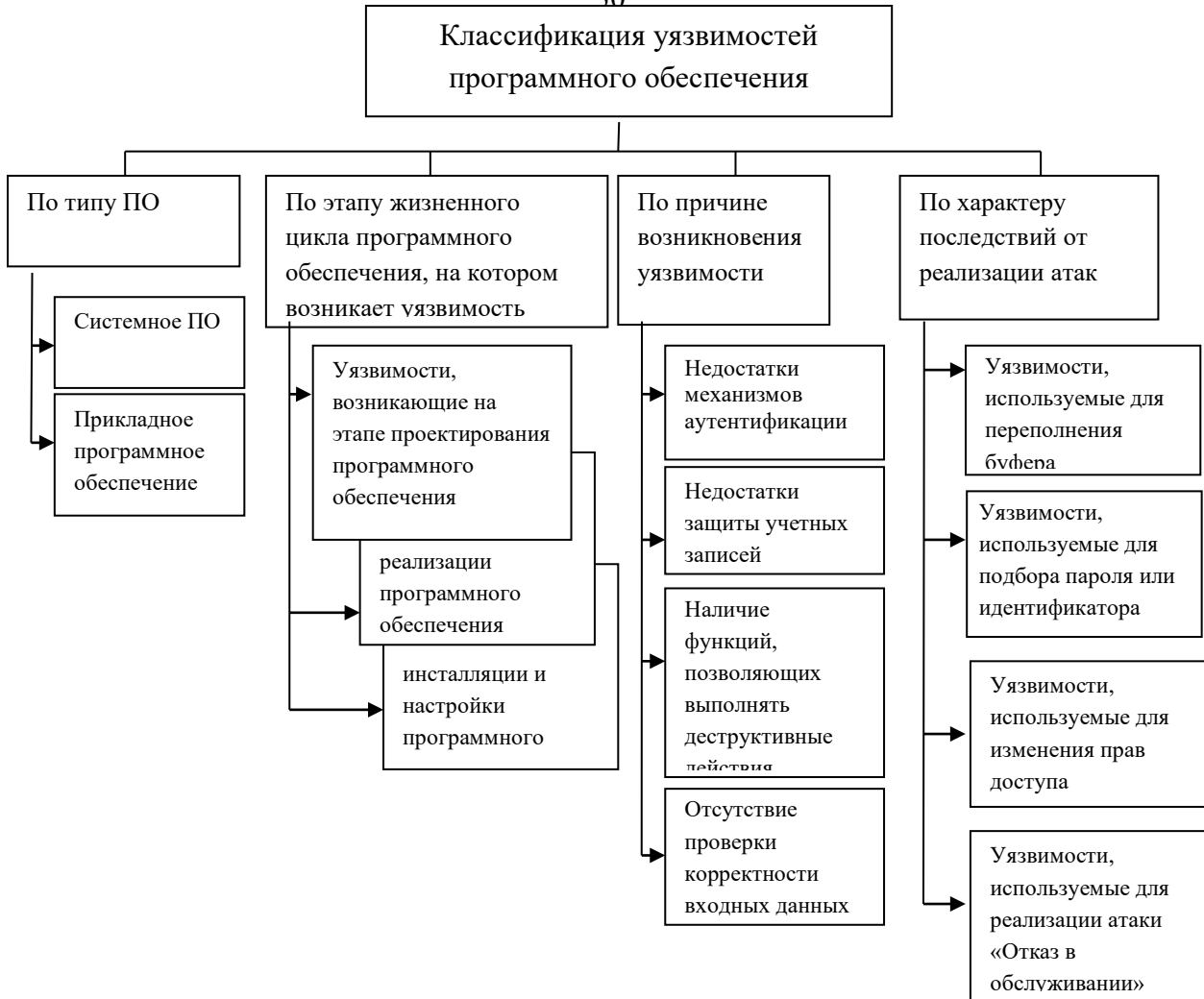
Рисунок 4. Классификация уязвимостей программного обеспечения
