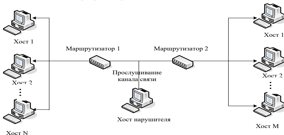
Рисунок 6. Схема реализации угрозы «Анализ сетевого трафика»
